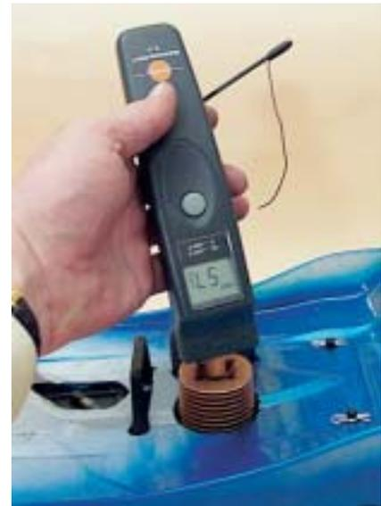
**Temperaturmessung mit einem Infrarot-Thermometer: 57 °C, das ist auch fürs Einlaufen zu kalt.**
